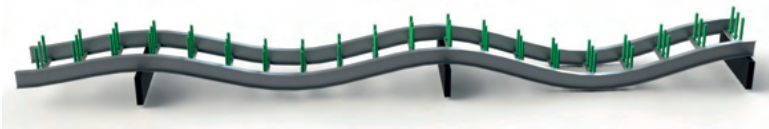
Détermination de la charge maximale admissible (CMA) sur plusieurs travées (CEI 61537)
