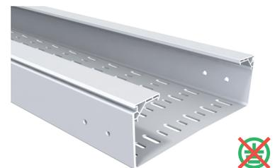
Según la norma americana UL 568 "Nonmetallic Cable Tray Systems", las Conducciones de Cables aislantes deberán resistir el ensayo ASTM D 149 con la aplicación de una tensión de 5000V CC durante un minuto sin sufrir perforación, excepto las bandejas diseñadas expresamente para disipar la electricidad estática.
