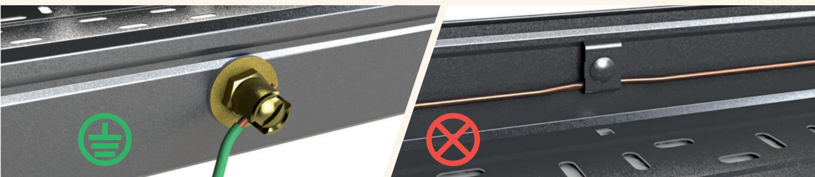
**En conclusión, las bandejas metálicas con recubrimiento metálico de BASOR ELECTRIC tienen continuidad eléctrica que asegura una conexión equipotencial entre ellas y no requieren de un conductor de protección a lo largo de su recorrido.**
