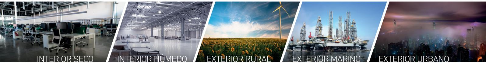
A partir de la experiencia y el conocimiento adquirido internacionalmente acerca de la corrosión, la norma ISO 9223 “Corrosividad de atmósferas” define en función de humedad y la presencia de contaminantes, distintas clases de ambientes C1 a C5 según el grado de corrosividad hacia los metales. La misma clasificación se utiliza en la ISO 9224 y en la ISO 14713-1 “Recubrimientos de cinc. Protección frente a la corrosión” (ver Sección 8).
