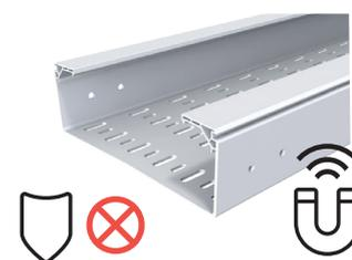
Si un SCC metálico presenta una buena continuidad eléctrica y está conectado a una conexión equipotencial de masa, disminuye el acoplamiento de la perturbación sobre los cables, al eliminar la corriente inducida, mejorando la Compatibilidad Electromagnética (CEM).
