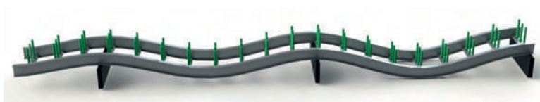
Determinación CTA en múltiples vanos (IEC 61537)
